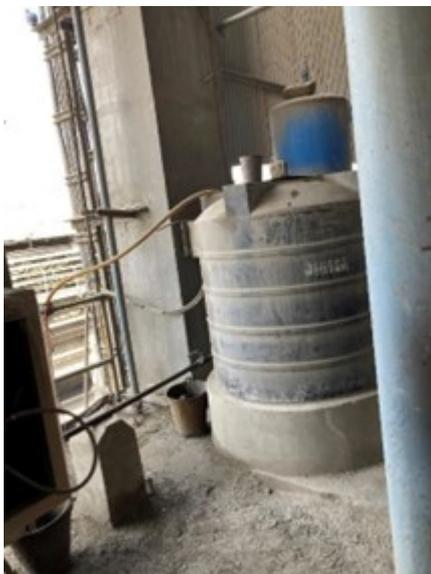
L'ajout de produit chimique d'aide au broyage au clinker (constituant du ciment) fonctionne dans une boucle PID fermée. La distribution de produits chimiques dépend du poids du clinker sur le tapis roulant. En plus du clinker, le régime de la pompe de distribution augmentera pour ajouter plus de produit chimique. Détails du fluide et paramètres de fonctionnement pour la sélection du débitmètre:
