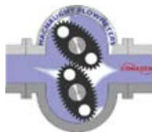
Dans le skid de distribution de produits chimiques existant, Aditya Techzone avait fourni un débitmètre de type à roues ovales de 10 mm, mais cela n'a pas fonctionné.
