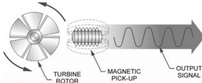
Pour de meilleurs résultats de mesure du débit, il est recommandé d'utiliser un débitmètre à turbine pour la mesure du débit de liquide ayant une viscosité inférieure à 10 Cst. Ici, la viscosité chimique est  $< 20$  Cst. Il n'est donc pas adapté.
