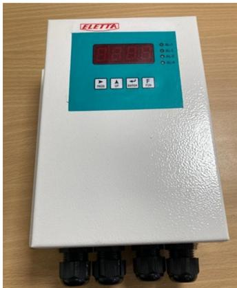
Toutes les unités de la série M sont fournies avec des afficheurs LED en montage panneau ou mural, alimentés en 24VDC convertit de la tension secteur en 230 VAC, dont la sortie 4-20mA est reprise sur la même boucle pour l'affichage local et la totalisation.
