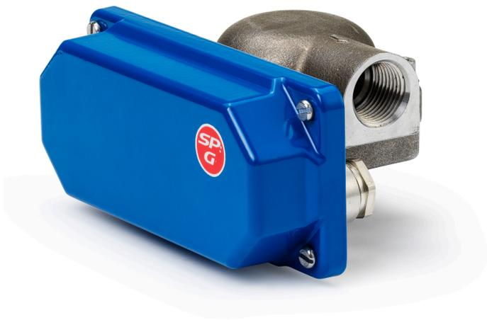
Unser Strömungsschalter SP-G ist für kleine Durchflussmengen und Leitungsgrößen ausgelegt. Er arbeitet nach dem Prinzip des variablen Durchflussbereichs, bei dem der Alarmschaltpunkt auf einen sehr niedrigen Durchfluss eingestellt werden kann und der Schalter dennoch in der Lage ist, große Durchflüsse zu verarbeiten, ohne einen großen Druckabfall zu erzeugen.
