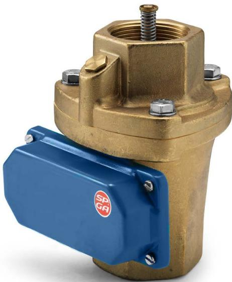
Der Durchflussschalter SP-GA ist so konzipiert, dass er bei einem sehr geringen Durchfluss einen Anfangsalarm auslöst und dennoch einen hohen Durchfluss ermöglicht, wenn Pumpen oder Ventile durch den Mikroschalter aktiviert werden. Die Funktion basiert ausschließlich auf der Aktivierung des Flüssigkeitsdurchflusses und wird daher nicht durch Änderungen des statischen Drucks beeinflusst.
