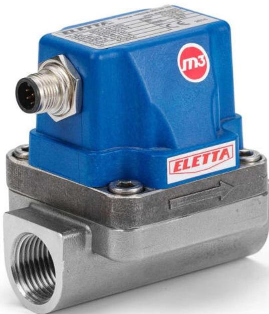
Le principe bien connu de mesure de la pression différentielle avec des plaques à orifice interchangeable est la base de cette construction. En combinaison avec deux capteurs de pression piézorésistifs absolus indépendants, il vous offre un débitmètre compact qui peut également être utilisé pour trois modes différents. Grâce au logiciel Eletta Flow Center, vous pouvez facilement changer de fonction pour :
