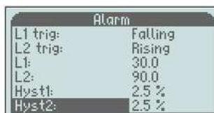
L'hystérésis est nécessaire afin d'éviter que l'alarme n'oscille (va et vient) lorsque le débit est proche du point de réglage.
