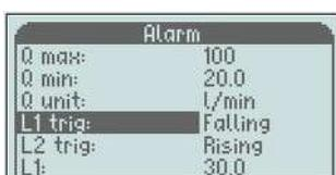
Faites défiler avec la touche "-" jusqu'à "Sens L1" ou "Sens L2" puis appuyez sur la touche " M " pour régler L1 ou L2 à la descente ou à la montée. L1 est réglé à la descente et L2 est réglé à la montée, par défaut, en usine.
