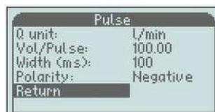
Pour quitter ce menu, faites défiler jusqu'à l'option "Retour" puis appuyez sur "M" ou maintenez "C" enfoncé pendant 2 secondes pour revenir directement au mode de fonctionnement. "Retour" vous ramène une étape en arrière dans le menu, le bouton "C" vous ramène directement au mode de fonctionnement.
