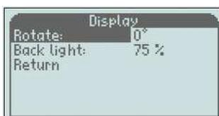
Pour changer l'orientation, faites défiler jusqu'à l'option "Ecran" et appuyez sur " M " puis lorsque "Pivoter" est en surbrillance, appuyez sur " M " pour se déplacer vers la droite. Utilisez les touches "+" ou "-" pour faire pivoter jusqu'à l'orientation souhaitée, puis confirmez avec " M ".
