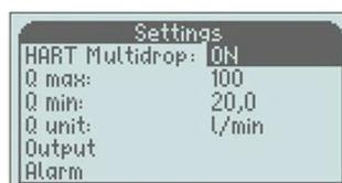
Utilisez "+" ou "-" pour régler "ON" ou "OFF" et confirmez avec " M ". Le mode HART Multidrop démarre ou s'arrête en même temps que vous confirmez. Appuyez sur " C " durant 2 secondes afin de revenir à la vue de fonctionnement.
