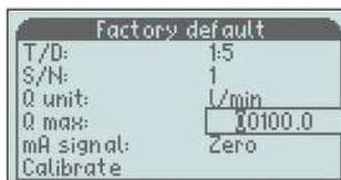
Faites défiler jusqu'à l'option "Q max" puis appuyez sur la touche " M " pour valider la sélection. Réglez la bonne valeur en fonction de la nouvelle plaque à orifice.
