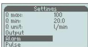
Pour modifier les paramètres d'alarme, faites défiler avec la touche "-" jusqu'à "Alarme" et appuyez sur la touche " M ".
