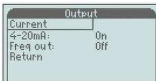
Dans ce menu, vous pouvez activer la sortie fréquence. Elle permet une fréquence de 200 à 1 000 Hz ou une impulsion.
