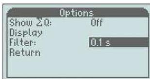
Pour modifier la valeur de filtre, faites défiler dans le menu "Options" jusqu'à ce que l'option "Filtre" s'affiche en surbrillance. Puis appuyez sur la touche "M" et pour valider la sélection. Pour régler la valeur, vous pouvez incrémenter d'un pas le chiffre avec "+/-" si nécessaire jusqu'à obtenir la valeur souhaitée en surbrillance et confirmer avec "M".
