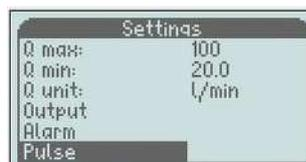
Pour modifier les paramètres d'"impulsion", faites défiler avec la touche "-" jusqu'à "Impulsion" et appuyez sur la touche " M ".
