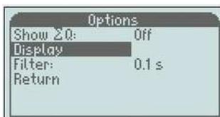
En fonction de l'orientation du montage du débitmètre, l'affichage peut être pivoté de 4 angles différents : "0°, 90°, 180° et 270°".
