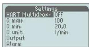
Le mode HART Multidrop limite le courant de sortie à 4 mA, à utiliser lorsque plusieurs instruments HART sont connectés à une seule boucle de signal. Pour activer le mode HART Multidrop ; lorsque "HART Multi" est en surbrillance, appuyez sur " M " pour vous déplacer vers la droite.
