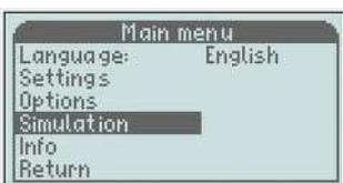
Cette fonction vous donne la possibilité de créer et de simuler un vrai signal mA provenant de l'appareil même si vous n'avez pas de débit. Par exemple, vous souhaitez vérifier d'autres instruments ou fonctions dans votre système. Dans ce cas, vous pouvez simuler un débit ou un signal mA souhaité en provenance de l'appareil. Le mode simulation permet également de tester la fonctionnalité HART, car le protocole HART transmettra les valeurs simulées.
