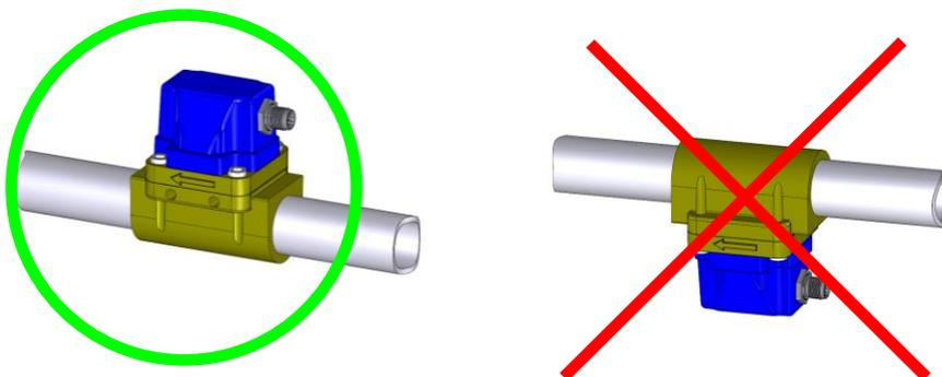
3) Stellen Sie sicher, dass das Messgerät in der richtigen Richtung installiert wird, die durch den Richtungspfeil angezeigt ist. Der Elektrische Anschluss sollte stromaufwärts zeigen.
