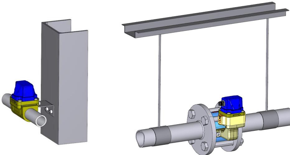
Sollte das Rohrsystem nun immer noch vibrieren, empfehlen wir die abgesetzte Montage des Messkopfes, siehe Sektion 11.1.
