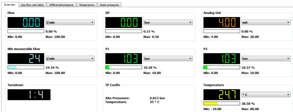
Die folgende Abbildung zeigt die Antwort von Flow Center bei atmosphärischen Bedingungen für Gasdurchfluss (NORM). Das Gas ist nun weniger dicht und das Messgerät verlangt einen höheren Differenzdruck, um die gleiche Masse pro Zeiteinheit messen zu können. Das Gerät misst nun zwischen 5 und 2900 mbar (Turndown 1:24 in Q). So verfügt das Gerät nun über einen Messbereich von 4-100 NI/min anstatt 10-100 NI/min.
