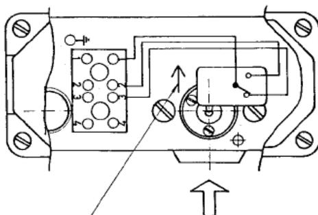
Lors du montage, assurez-vous que l'écoulement va dans le sens de la flèche.
