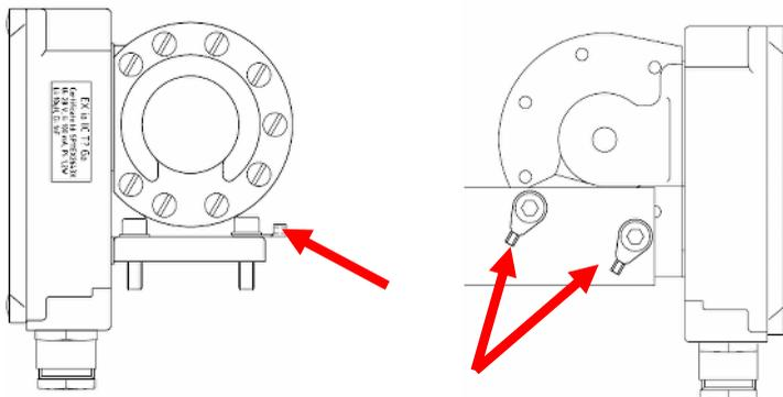
Bornes de masse pour V-GL/FA version Ex pour raccordement au système de tuyauterie
