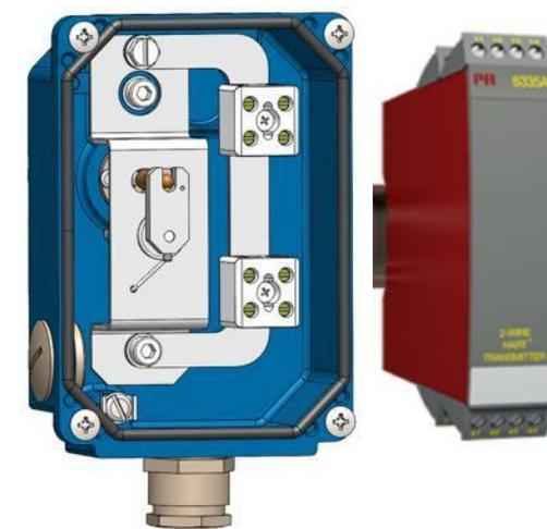
Le R5C est équipé d'un potentiomètre céramique délivrant un signal résistif à 4 fils. Ce signal résistif est converti en signal 4-20 mA directement proportionnel au débit mesuré par un transmetteur externe. Le potentiomètre céramique permet d'utiliser le transmetteur de débit R5C même en zone dangereuse avec présence de radioactivité.
