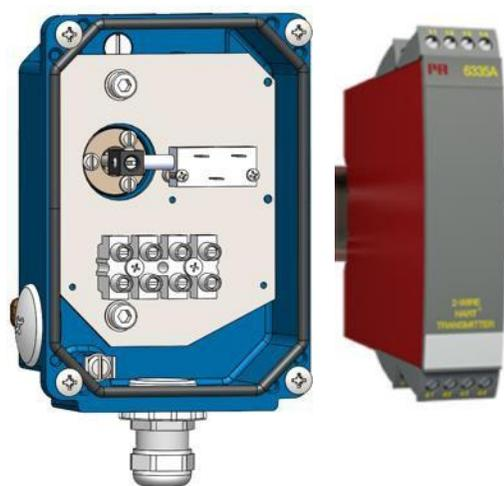
Le RS est équipé d'un potentiomètre linéaire délivrant un signal résistif à 4 fils. Ce signal résistif est converti en signal 4-20 mA directement proportionnel au débit mesuré par un transmetteur externe. Cette configuration permet d'utiliser le transmetteur de débit RS même dans des zones à champs magnétiques très élevés.
