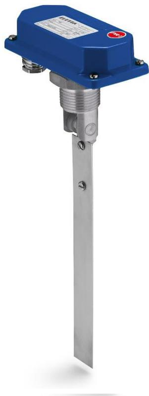
Le contrôleur de débit à palette Eletta PR1 utilise le débit du liquide pour activer la palette à ressort et le microrupteur pour déclencher une alarme en cas d'arrêt ou de reprise du débit. L'installation est simple : la palette peut être coupée sur site à la longueur souhaitée, en fonction de la taille de la conduite. La palette s'aligne parfaitement avec le débit et crée une très faible perte de charge. Cette fonction n'est valable que dans un seul sens d'écoulement.
