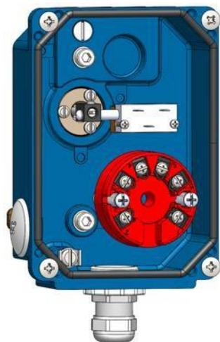
Le RH est équipé d'un potentiomètre linéaire, fournissant un signal résistif à 4 fils. Ce signal résistif est converti en un signal 4-20 mA directement proportionnel au débit mesuré par un transmetteur à 2 fils. Le transmetteur 4-20 mA intègre la communication HART.
