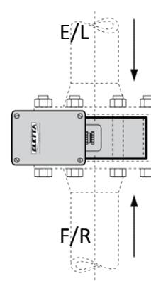
**Beispiel:** D2-GL, Dimension DN15, Messbereich 4 – 8 l/min, Medium Wasser, Richtung A/R
