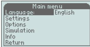
Scrollen Sie mit den Tasten + oder - im Menü nach oben und unten. Wenn der Text hervorgehoben (schwarz) ist, bedeutet das, dass Sie den Parameter ändern können.
