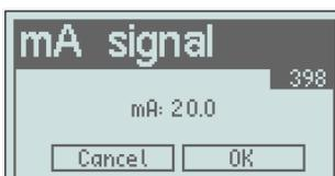
Das Programm springt automatisch bis 20 mA. Wiederholen Sie die Einstellsequenz wie oben und drücken Sie die Taste „M“ zur Bestätigung.
