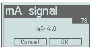
4 mA werden angezeigt und jetzt müssen Sie diesen Wert mit Ihrem Multimeter vergleichen. Bei Bedarf können Sie jetzt das Signal vom Durchflussmesser mit den Tasten „-/+“ nach oben und unten 10 Schritte anpassen. Jeder Schritt entspricht 0,05 mA. Stellen Sie so nah wie möglich ein und bestätigen Sie mit der Taste „M“.
