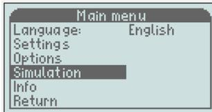
Diese Funktion bietet Ihnen die Möglichkeit, ein reales mA-Signal vom Gerät zu erzeugen und zu simulieren, auch wenn kein Durchfluss vorhanden ist. Wenn Sie zum Beispiel andere Geräte oder Funktionen in Ihrem System überprüfen möchten. In diesem Fall können Sie einen gewünschten Durchfluss oder ein mA-Signal vom Gerät simulieren.
