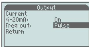
Verwenden Sie +/-, um zu „200-1.000 Hz“ oder „Impuls“ zu wechseln **Bestätigen Sie die Auswahl mit der Taste „M“**
