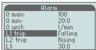
Scrollen Sie mit der Taste „-“ zu L1 ausl. oder L2 ausl. und drücken Sie die Taste „M“, um L1 oder L2 auf fallend oder steigend einzustellen. Werksseitig ist L1 auf fallend und L2 auf steigend eingestellt.
