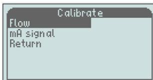
Scrollen Sie nach unten zu „Kalibrieren“ und drücken Sie die Taste „M“. Wenn „Durchfluss“ hervorgehoben ist, drücken Sie die Taste „M“ erneut.
