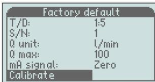
Das mA-Ausgangssignal des Messgeräts kann ebenfalls kalibriert werden. Das ist bereits vor dem Verlassen des Werks durchgeführt, wenn Sie aber aus irgendeinem Grund vermuten, dass es nicht korrekt ist, gibt es die Möglichkeit, das mA-Signal wie folgt einzustellen; Trennen Sie die Kabel vom mA-Ausgang (3 und 4 am Anschlussblock) Verbinden Sie ein kalibriertes mA-Messgerät (Multimeter) mit den Anschlüssen 3 und 4.
