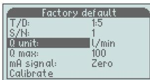
Scrollen Sie nach unten zu „Q Einheit“ und drücken Sie die Taste „M“, um nach rechts zu gelangen.
