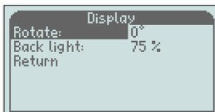
Um die Ausrichtung zu ändern, scrollen Sie nach unten zu „Display“ und drücken Sie „M“. Wenn „Drehen“ hervorgehoben ist, drücken Sie „M“, um nach rechts zu gelangen. Verwenden Sie „+“ oder „-“, um zum gewünschten Winkel zu drehen und bestätigen Sie mit „M“.
