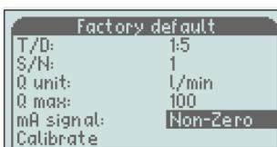
Scrollen Sie zum Ändern nach unten zu „mA-Signal“ und drücken Sie die Taste „M“, um nach rechts zu gelangen. Ändern Sie dann mit „-/“ und bestätigen Sie mit der Taste „M“
