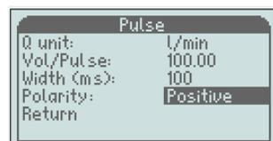
Scrollen Sie mit der Taste „-“ nach unten zu „Polarität“ und drücken Sie die Taste „M“, um die Polarität auf positiv oder negativ einzustellen.
