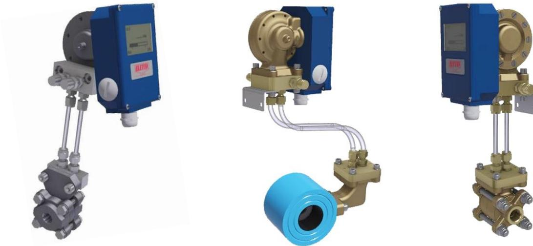
En standard, deux flexibles en plastique PA de 1,75 m (5,74 pieds) sont livrés avec le kit de montage séparé. Le diamètre est de 6 mm (0,23 pouce) et peut résister à une température maximale de 90 °C (194 °F) et à une pression maximale de 16 bar (232 PSI).
