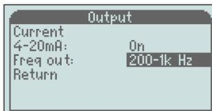
Pour activer la sortie, faites défiler jusqu'à l'option «Fréq out» et appuyez sur la touche «M».
