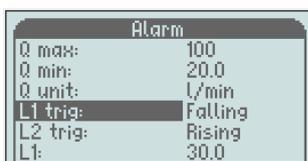
Faites défiler avec la touche «-» jusqu'à Trig L1 ou Trig L2 puis appuyez sur la touche «M» pour régler L1 ou L2 à la baisse ou à la hausse. L1 est réglé à la baisse et L2 est réglé à la hausse, par défaut, en usine.
