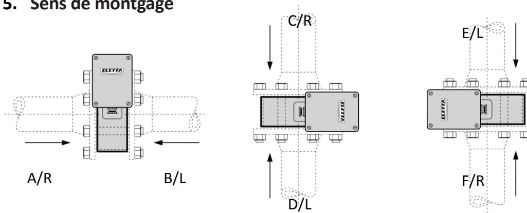
**Exemple:** D2-GL, dimension DN15 Gamme de mesure 4 – 8 l/min, fluide eau, sens A/R
