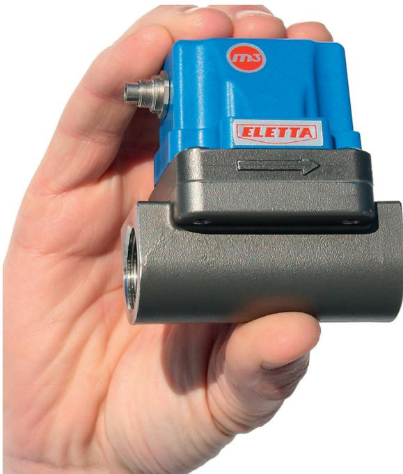
Le principe de mesure de la pression différentielle bien documenté avec des plaques à orifice interchangeable est la base de cette construction. En combinaison avec deux capteurs de pression piézorésistifs absolus indépendants, il vous offre un débitmètre compact qui peut également être utilisé pour trois modes différents. Grâce au logiciel Eletta Flow Center, vous pouvez facilement changer de fonction pour :
