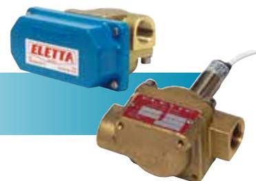
El **SP-GA** es un modelo más grande con una conexión DN40 y un microinterruptor mecánico. También tiene un punto de referencia ajustable in situ dentro de un campo de 3-70 l/min permitiendo una afluencia máxima de 300 l/min. Hay filtros y reductores adaptables a tubos más pequeños de hasta DN25.
