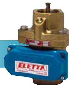
El **PR1** es un interruptor de tipo paleta de bajo coste apto para aplicaciones donde se requiere poca exactitud. El setpoint más bajo es de aprox. 100 l/min en un tubo DN50. El **PR1** da a una pérdida de presión muy pequeña cuando la paleta se alinea con el flujo de caudal. Estos modelos se fabrican con dimensiones desde DN50 hasta DN250.
